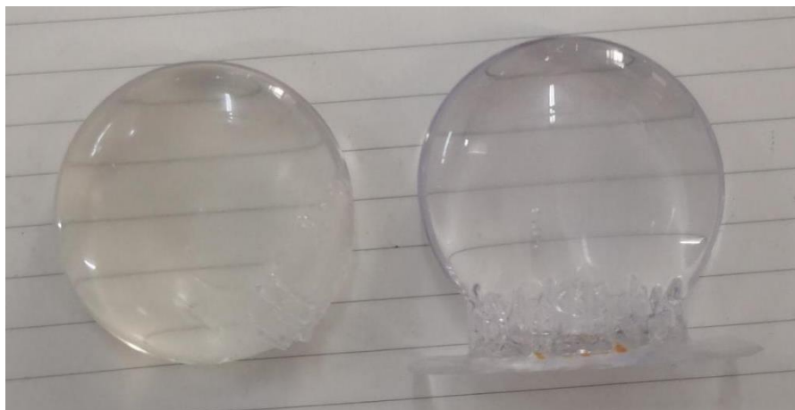
图 3 树脂 4（左）与 PUA1 树脂（右）实物模型图对比
