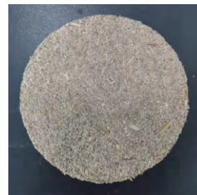
图 1 废弃秸秆/聚己内酯吸声复合材料
